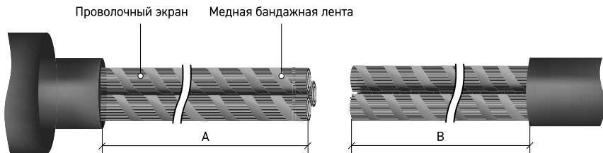
**2.1** Удалить с кабеля оболочку и межфазный заполнитель согласно рисунку и таблице (разделка на размер А должна проводиться со стороны кабеля с надетым кожухом).
