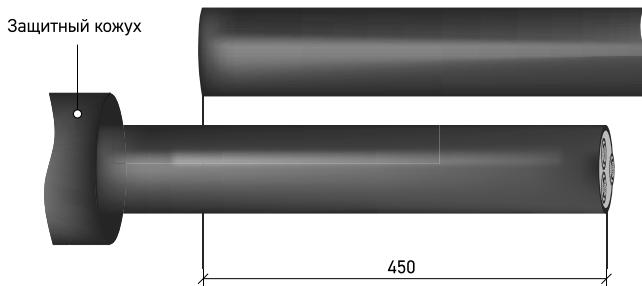
**1.1** Распрямить один конец кабеля на длине 2000 мм, другой – 1500 мм, очистить их от загрязнений и расположить их друг напротив друга с перехлестом в 450 мм.
